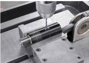
2. Percez le boîtier du ressort à gaz pour la purge au milieu à l'aide d'un foret hélicoïdal (diamètre du foret env. 4 mm).
