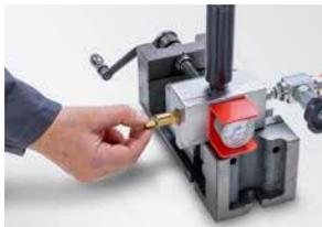
5. Ouvrir lentement la soupape d'admission de l'unité de remplissage jusqu'à ce que la pression de remplissage prédéfinie soit atteinte. Puis fermer cette soupape. Avant de dévisser les ressorts à gaz, évacuer la pression de l'unité de remplissage par le biais de la vanne de purge latérale !
