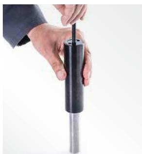
1. Pour la purge, maintenez les ressorts à gaz en position verticale avec le piston vers le bas. Tourner délicatement la vis de déchargement (⇒ *NU, 4.7 Kits de réparation et jeux d'outils*) jusqu'à ce que l'écoulement d'azote soit audible.
