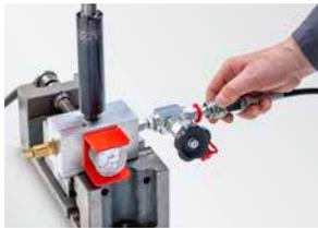
3. Raccorder le flexible de chargement à l'unité de remplissage. La soupape d'admission de l'unité de remplissage doit être fermée !
