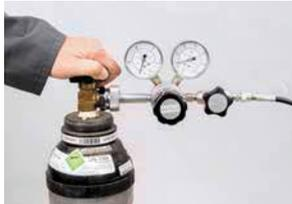
4. Visser la bouteille d'azote avec précaution. S'assurer de l'absence de fuites. Régler la pression de remplissage des ressorts à gaz au niveau du manodétendeur.
