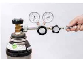
2. Raccorder le flexible de chargement sur le manodétendeur de la bouteille d'azote.
