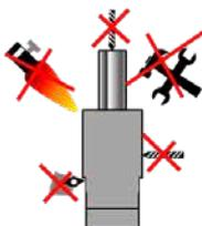
Ne pas traiter les ressorts à gaz par voie thermique ou mécanique.
