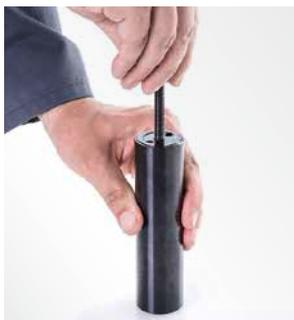
2. En comprimant complètement le piston, vérifier la purge du ressort à gaz à la main. Si c'est impossible, serrer à nouveau la vis de déchargement.
