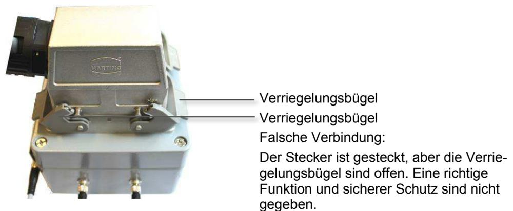
Abb. 3-13 Falsch: Verriegelungsbügel geöffnet
